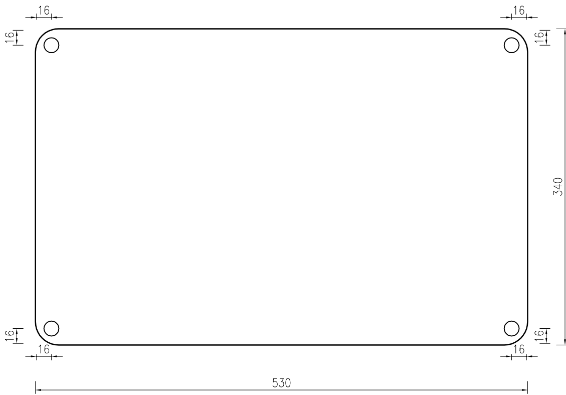
膨胀螺栓设置示意图
